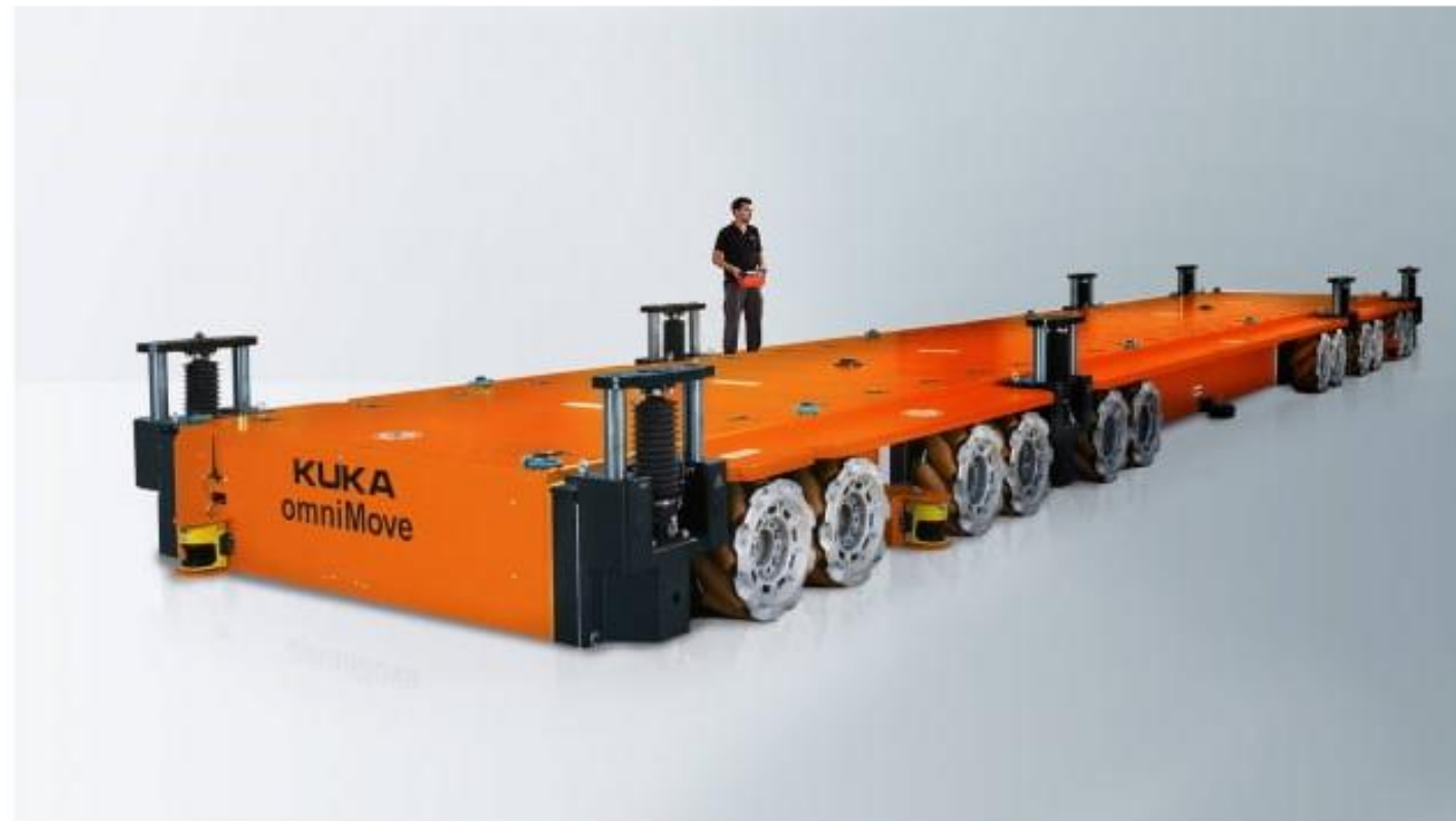
독일 쿠(KUKA)사가 개발한 무인운반차에는 메카닉 휠을 장착했다.[KUKA 홈페이지]
