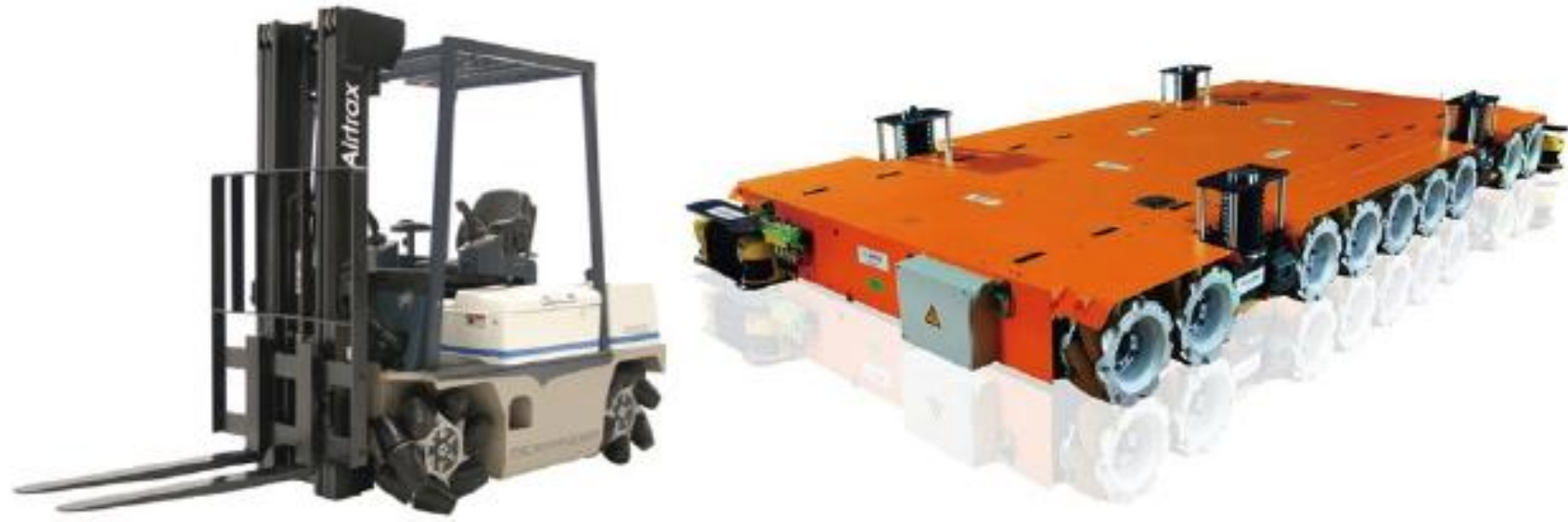
메카넘 휠이 부착된 지게차 (Airtrax社)와 AGV(Kuka社)
