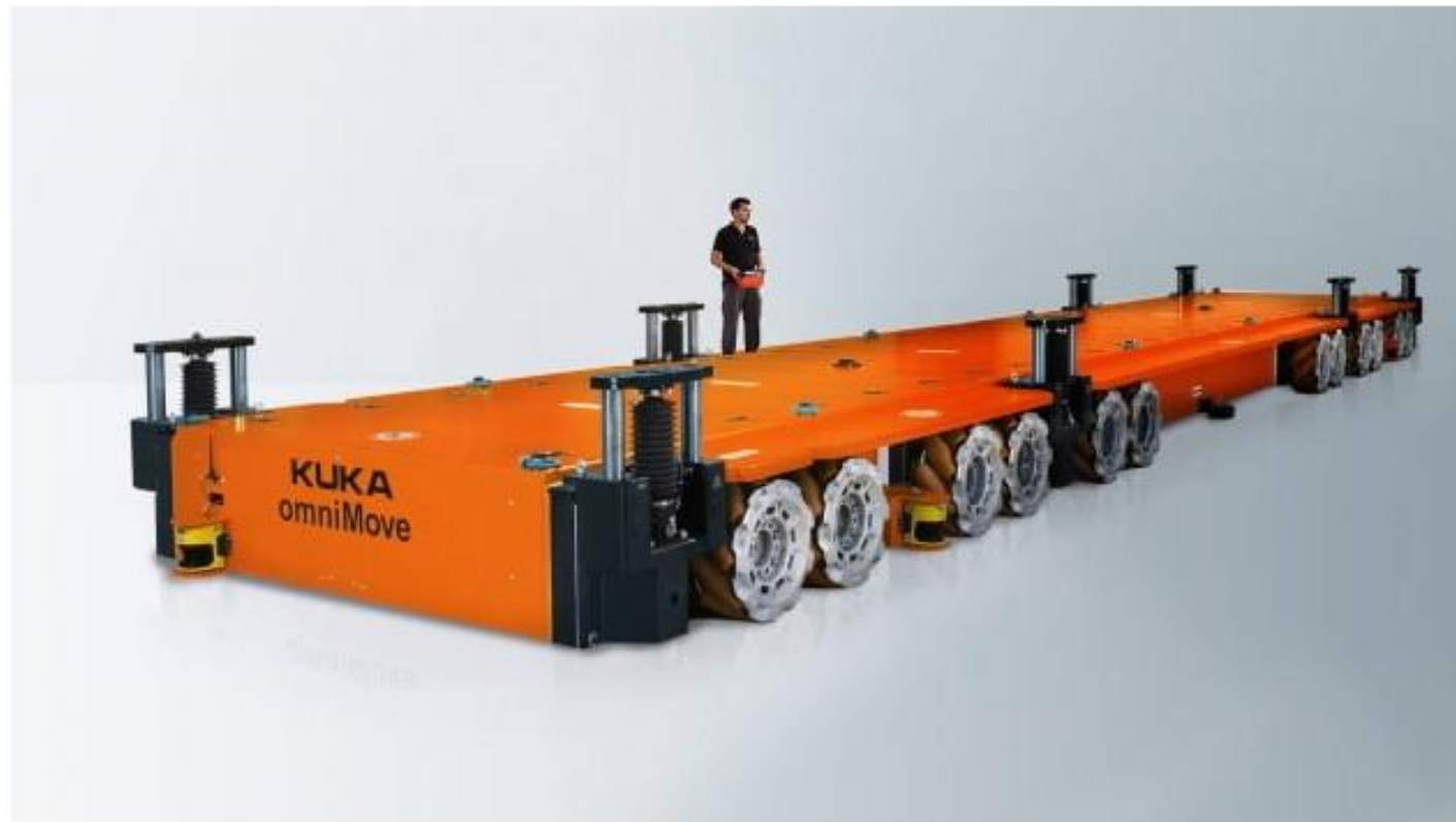
독일 쿠(KUKA)사가 개발한 무인운반차에는 메카넘 휠을 장착했다.[KUKA 홈페이지]
